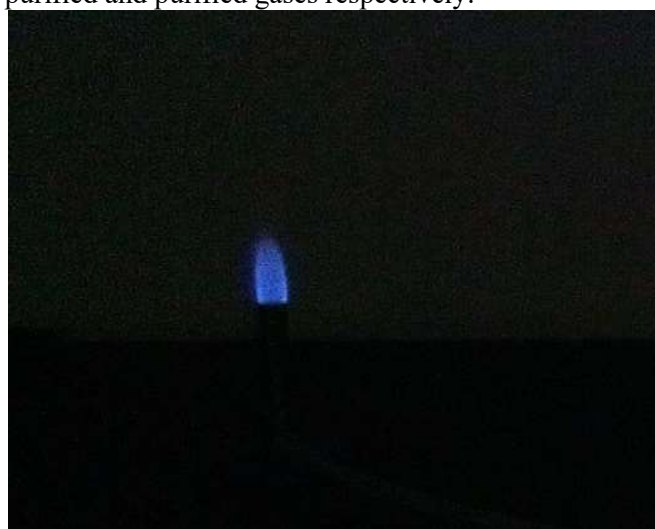
Fig. 3 Raw biogas flame
